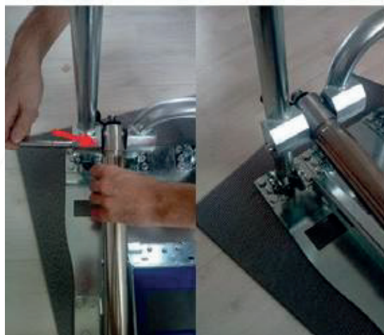
Slika 33 - Vstavljanje varnostne zaponke
